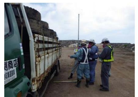
写真-14-3 搬出車両の放射線量測定
