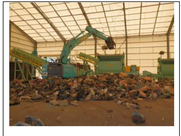
写真-4 粗大物破砕状況
