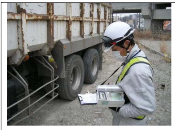
写真-11 搬出時の空間線量測定
