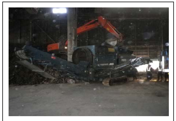
写真-7 津波堆積物処理状況（トロンメル）
