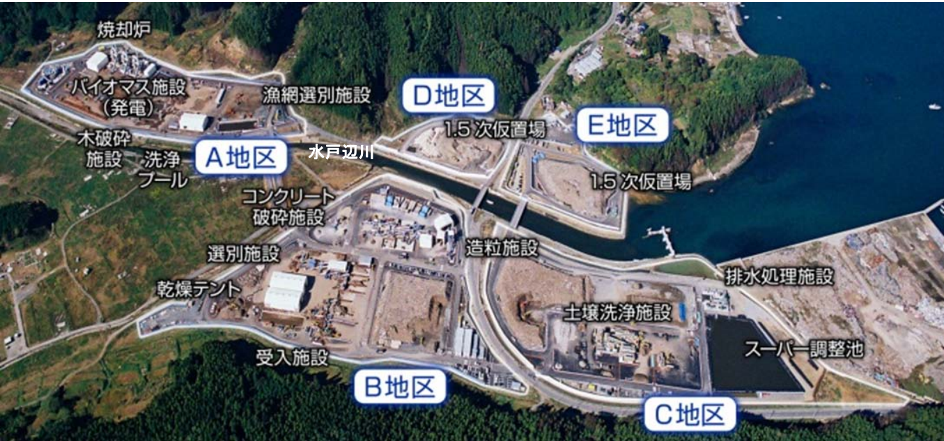
図-1 二次仮置き場の施設配置
