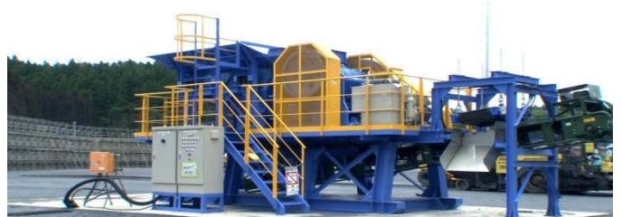
写真-9 コンクリートガラ破碎機
