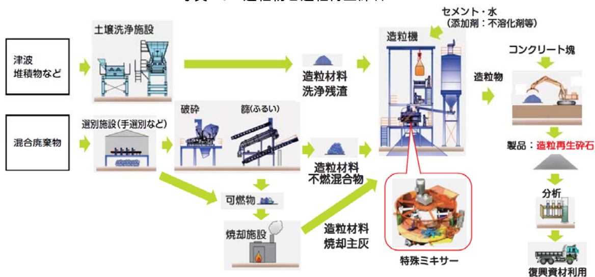
図-5 造粒再生碎石の製造フロー
