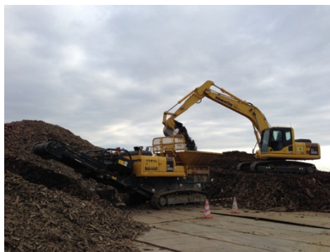
写真-3 木くず破碎状況
