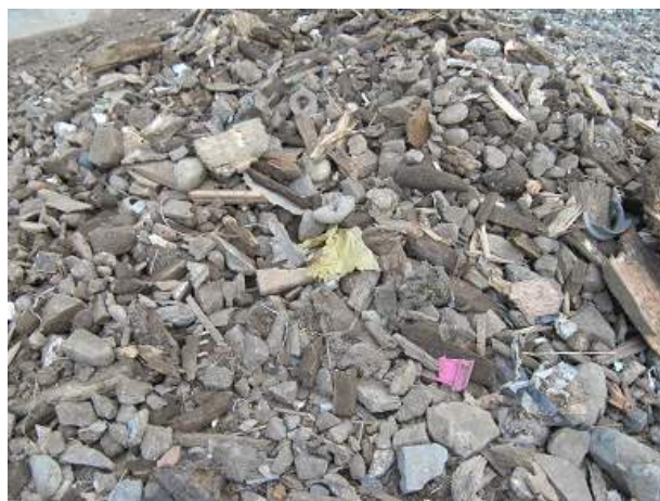
写真-8 分別除去された不燃物
