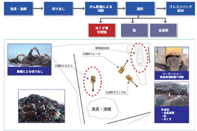
図-10 布団・漁網せん断設備
