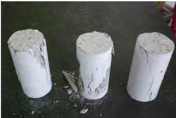
写真-付 2.27 圧縮試験体-試験後
