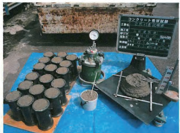
写真 2.6 試験体製作状況(生コンクリート検査)
