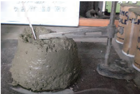
写真-付 2.22 スランプ検査状況
