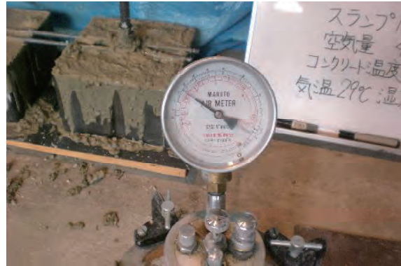
写真-付 2.23 空気量検査状況
