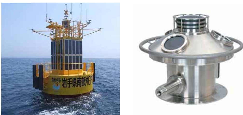
図 3. 3. 9 GPS 波浪計 (左) 14) と海象計 (右) 15)
