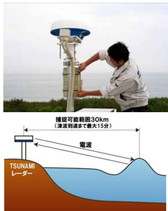
図 3.3.19 TSUNAMI レーダーと観測の概念 22)
