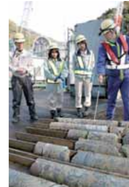
既存堤体から抜き取ったコンクリートサンプル。80年経た今も十分な強度が
