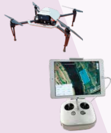
測量時に使用するドローンと操作用のタブレット
