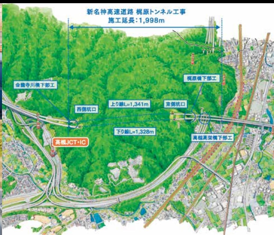
「梶原トンネル工事」の全体平面図。トンネルの他、橋脚・橋台・切土など、工種は多岐に渡る（提供：清水建設（株））
