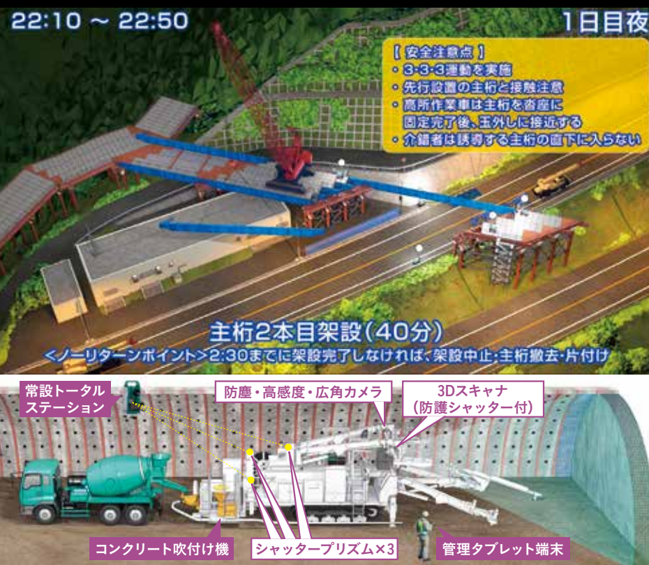
上／名神高速道路の上空を横断する仮橋脚を架設する際に作成したシミュレーション動画。下／トンネル掘削レーザーガイダンスシステムの概要図（いずれも提供：清水建設（株））
