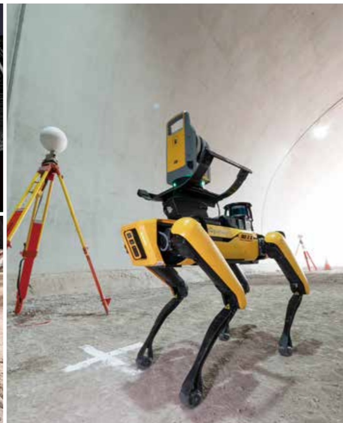
四足歩行ロボットに3Dレーザースキャナを搭載し、自律で坑内の出来形管理をさせている。これもデジタルツインとSLAM技術の融合で、GNSSなしでも自己位置を認識できることで可能になった。(左画像2枚提供：五洋建設株)
