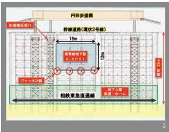
1. 地上部の全景 2. 周辺と地下部のパース 3. 施工部の全体断面図
