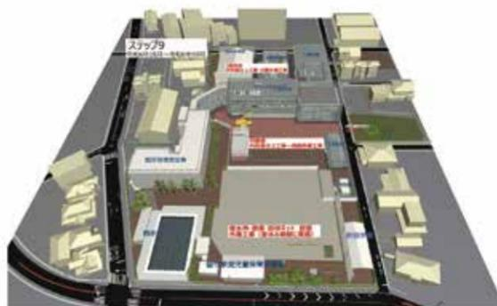
BIMで作成した本工事の施工ステップ図。動線確保や仮設物の移設など、複雑な手順の説明に活用した。(画像提供:松井建設株)
