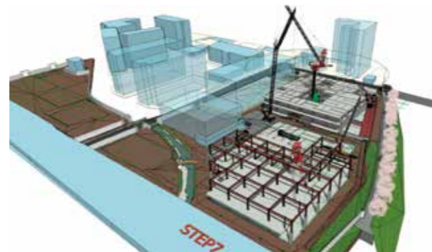
BIMによる施工手順検討画面。工程が複雑だからこそ、建て方を細かく決めておくことが重要になる。（画像提供：株松村組）
