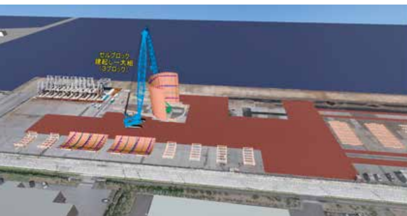
上／4 函の鋼板セルをモデリングし、干渉部分の確認などに用いた。 左／鋼板セル製作ヤードの BIM/CIM モデルで作られた 4D シミュレーション。 鋼板の加工からクローラークレーンによる建て起こしまで、手順を視認できる。(ともに画像提供：東亜建設工業株)
