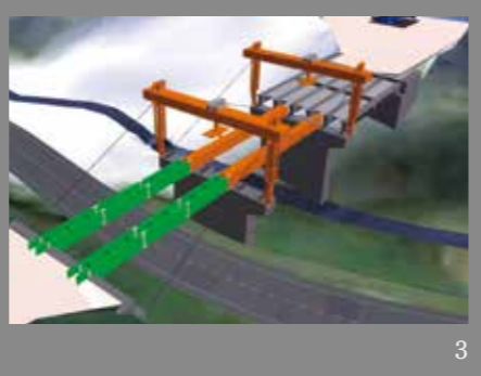
1. MR技術を使った検査の様子 2. 主桁を組み立てる様子 3. 4DCIMを活用した工程管理
