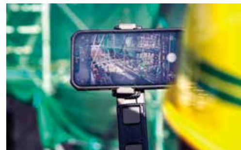
遠隔臨場で用いるスマートフォンの画面。「ウェアラブルカメラだと、装着してる本人にどこが映っているかわかりにくいので、この方法に落ち着きました」（海沢所長）
