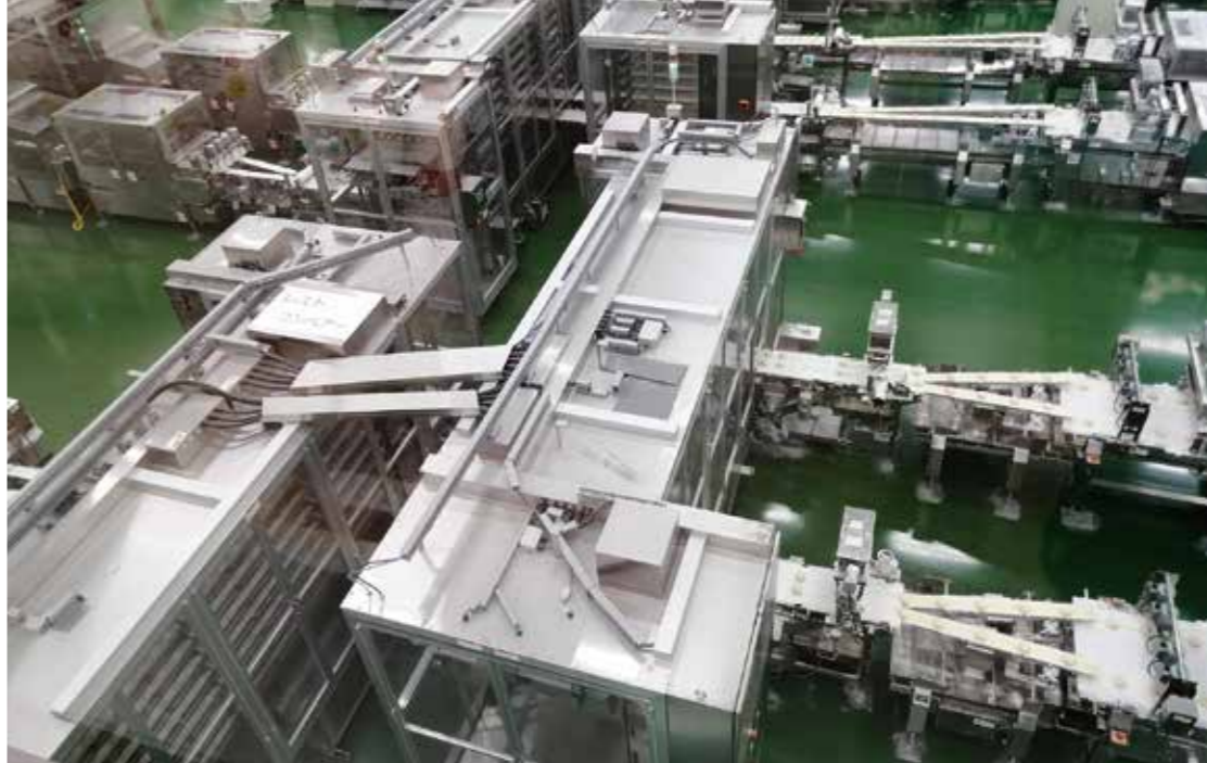
左、左下/厳重に管理された整形室。中華まんの材料が隣接するエリアから自動搬送設備により自動供給される。これらが稼働する様子は、2階見学者通路から見ることができ。
