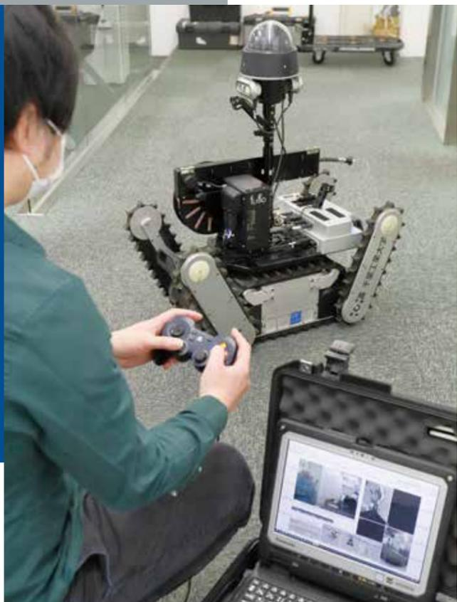
る。東日本大震災に伴い大きな被害を受けた福島第一原子力発電所、この建屋の状況調査と解体に至る経緯だ。fuRoは震災以前からNEDOのプロジェクトに参画し、地下空間や建造物内での事故を想定したレスキューロボット「Quince」を開発していた。機体の全面にクローラーを装備し、階段や障害物をもとめせず前進、空間内の探査や応急措置を行う。fuRoは震災直後からこれをベースとして線量計や通信ケーブルの巻取り装
