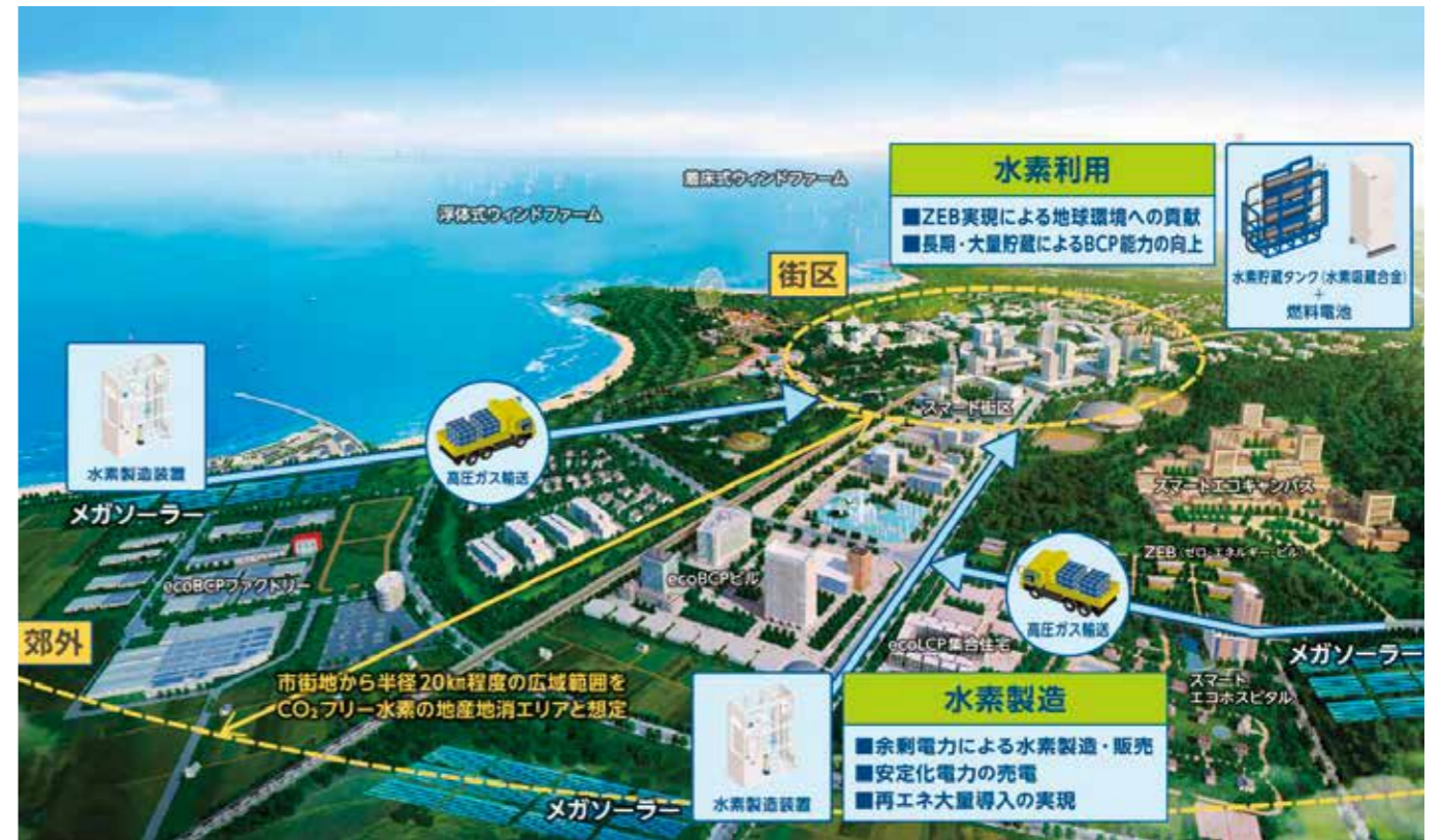
市街地を中心にCO 2 フリー水素の地産地消エリアを想定し、郊外のメガソーラーで水素を製造、エリア街区内に輸送する。水素の吸蔵・放出に、実績あるシミズ・スマートBEMSを活用することで、施設の需要に応じたエネルギーの最適運用が可能になる。
