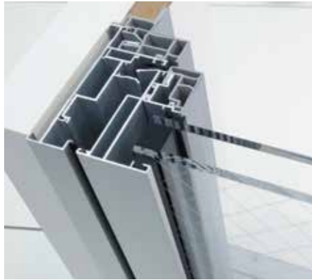
上／窓には、夏季は日射熱を反射し、冬季は屋内の熱を放射しにくいアルミと樹脂の複合サッシとアルゴンガスを封入した複層ガラスを採用した 右／壁には高性能断熱材を通常の2倍以上の厚さで吹付けた。厚さ、工程管理には細心の注意が必要になる（提供：株式会社鴻池組）
