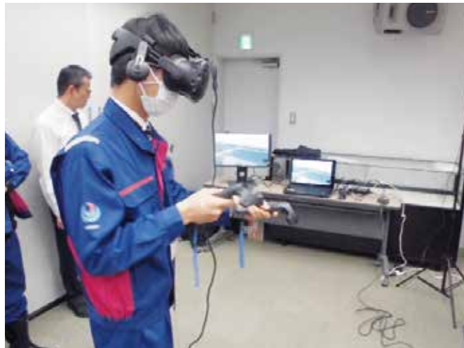
VRゴーグルに投影される橋梁基礎を事務所確認、コントローラーで測量する。(提供:国土交通省北陸地方整備局信濃川河川事務所)
