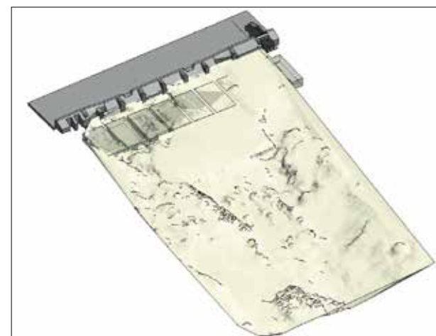
ナローマルチビームにより濁った河床部の深浅や出来形を確認、3Dデータとして可視化、共有している。(提供：鹿島建設株)
