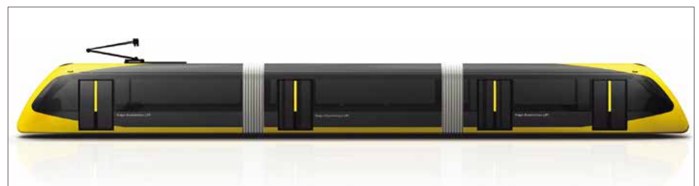
LRT車両は全長約30m、座席数は50席で定員は160人。「雷」や、その恵みで豊かに実った「稲穂」をイメージさせる鮮やかな黄色をメインカラーに採用した。緩やかなスロープで昇降する停留場の高さは30cm、車両の乗降口も同等の高さで乗降には段差がない。(提供：宇都宮市)
