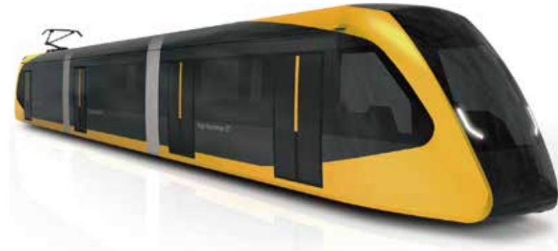
運転最高速度は時速40km。車内には車椅子やベビーカーに対応するフリースペースも設ける。（提供：宇都宮市）
