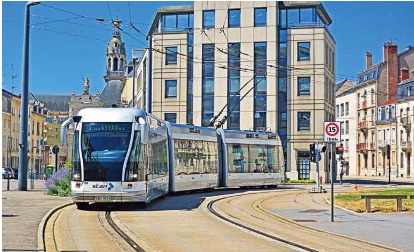
フランス・ロレーヌ地方の都市ナンシーを走るゴムタイ tram。トロリーバスの施設を改修し、都心部は1本のレールによるガイド走行、郊外部ではトロリーバスとして走行する。こうした挑戦的な試みが今後の都市交通の理想形を示唆する。
