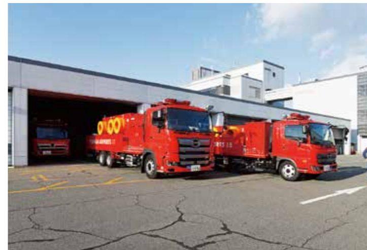
浸水時の排水機能の強化を目的として3台の大型排水ポンプ車を新規配備した。
