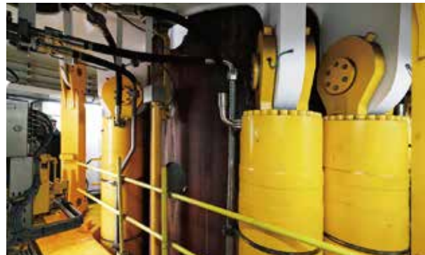
連続式油圧ジャッキシステムは、4本のピンのうち常に3本でレグを昇降させ、残りの1本のピンが挿し替え作業を行うことで昇降を止める必要がない。
