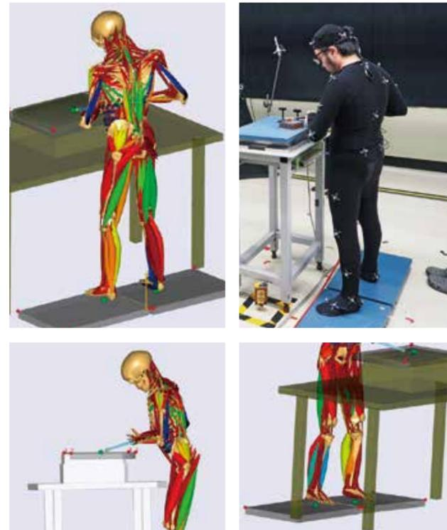
全身に41個、道具や土台にも複数のセンサーを装着し、頭から足の指先までを測定する。収集できる筋肉、骨格、体幹のデータは926項目に及ぶ。そうした人体データを基に上級技能者が細部にわたって後進の指導に当たる。([グラインダー作業]の3点の画像提供:マツダ株)
