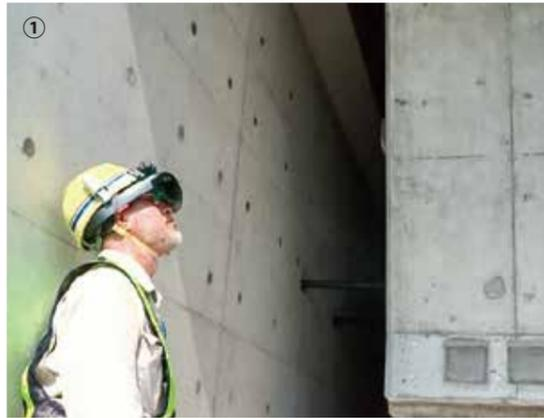
① ヘッドマウントディスプレイ (Microsoft HoloLens) を使って周囲を見渡すだけで3Dモデルを生成、現場の状況を即座にデータ化できる。②が実際に使用している様子、③が生成された3Dモデル、そして④がもともなった現場の写真である。この技術も「アクセラレートフィールド」によって検証。インフラの維持管理のコストを削減する新技術として期待を集めている。(いずれも提供: 愛知道路コンセッション株)
