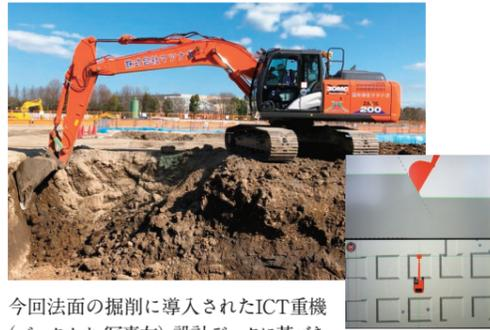
今回法面の掘削に導入されたICT重機(バックホウ・写真左)。設計データに基づき、「どの部分をどれだけ掘ればよいか」が運転席の画面に表示される(写真右)。(提供:株大林組)
