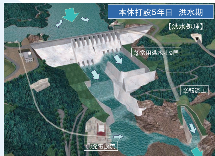
新丸山ダム本体の施工図(本体打設5年目の洪水期の様子)。小規模洪水の際は、①発電用水路、②転流工を利用し、洪水を迂回させる。大規模洪水の際は、①発電用水路、②転流工に加えて丸山ダムゲートの操作を行い、③堤内バイパスなどから洪水を流す計画。(提供：国土交通省中部地方整備局)
