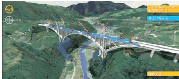
河内川橋施工プロセスCG(提供:中日本高速道路株)
