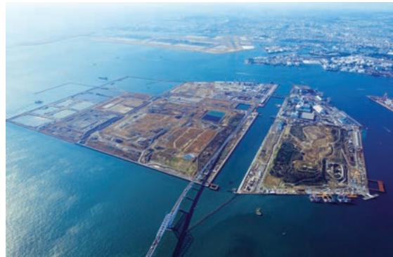
上／中央防波堤の空撮写真。写真右側が北の方位にあたる。 (提供：東京都) 左／水路幅約200mは、奇しくも競技場規格に合致していた。内側防波堤ではグランドスタンドや艇庫、並走コースの整備に着手している。奥に見える東側の締切堤は、コース内に橋を架ける作業船が出入するため、開いたままになっている。
