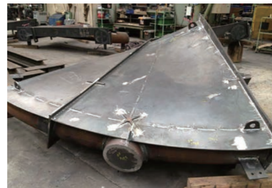
工場製作中の床鋼板部材
