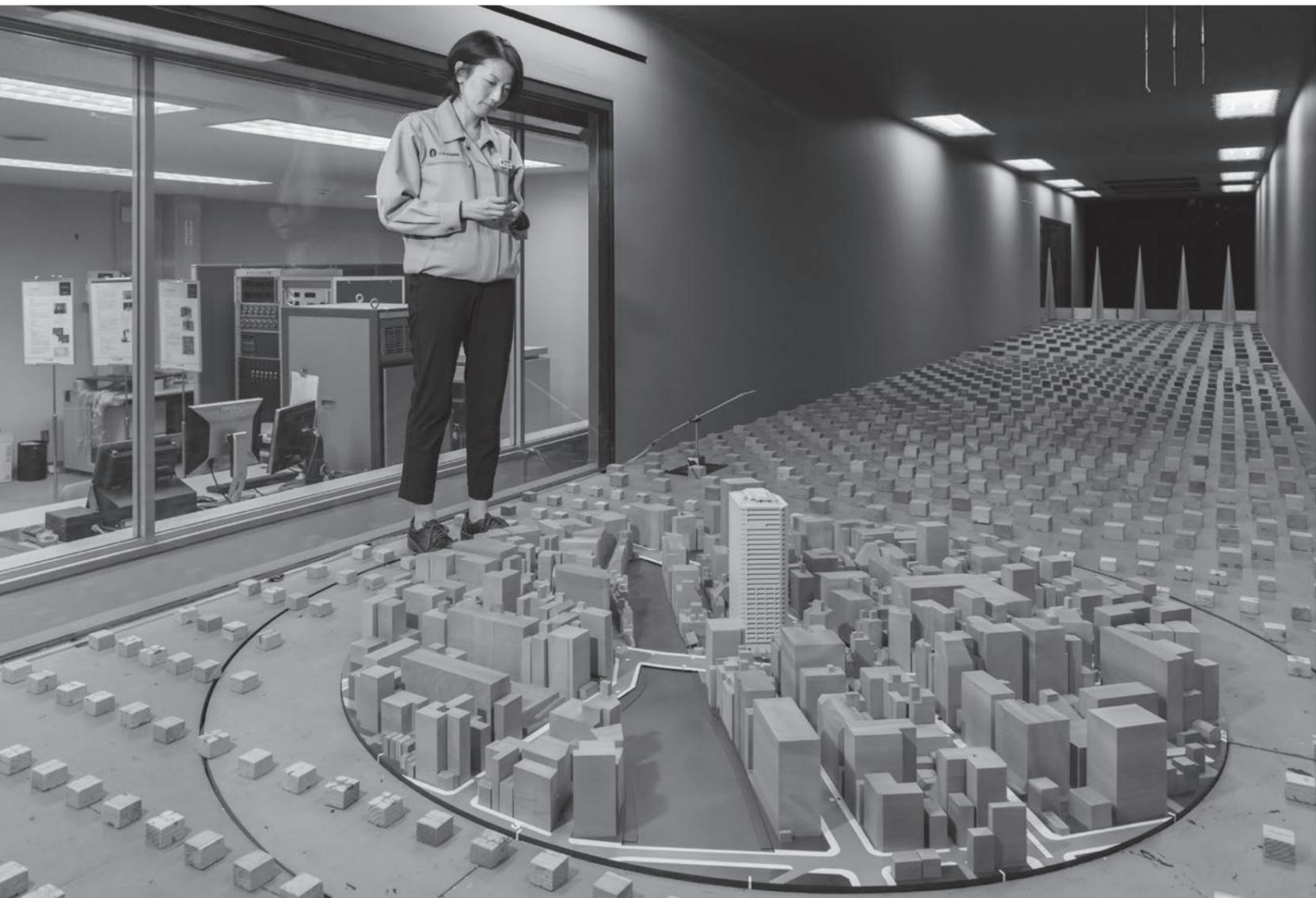
風洞実験の様子。植栽を置く場所によって建物周辺の風環境が変わるため、何十回も試行錯誤を重ねながら実験を進める。
