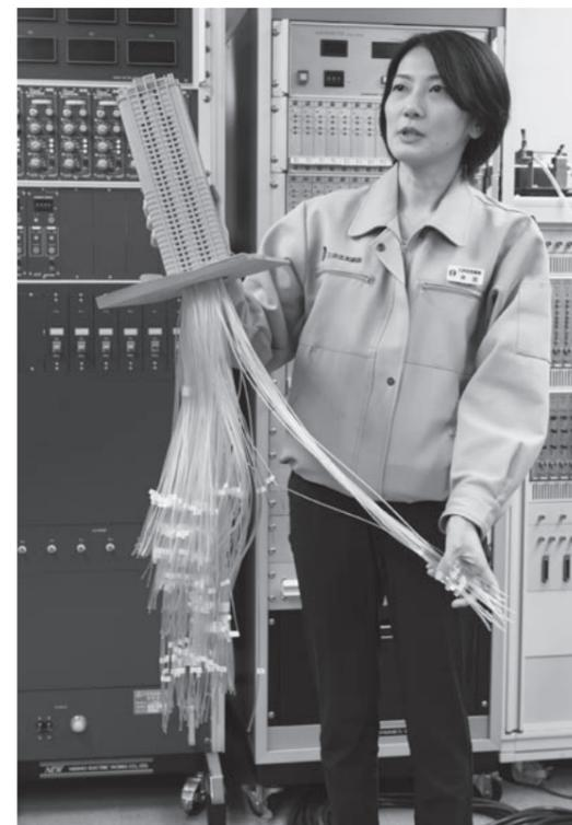
風洞実験に使う建物の模型には孔が開いていて、チューブが繋がっている。このチューブに繋がれたセンサーで風の圧力を測定、分析するという。
