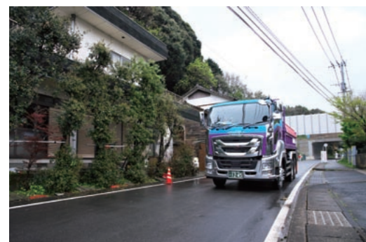
現場への進入路は狭く、住宅に接近している。時速10kmでダンプがゆっくりと通り過ぎていく。路面には振動や走行音を減衰する低振動舗装を施した。
