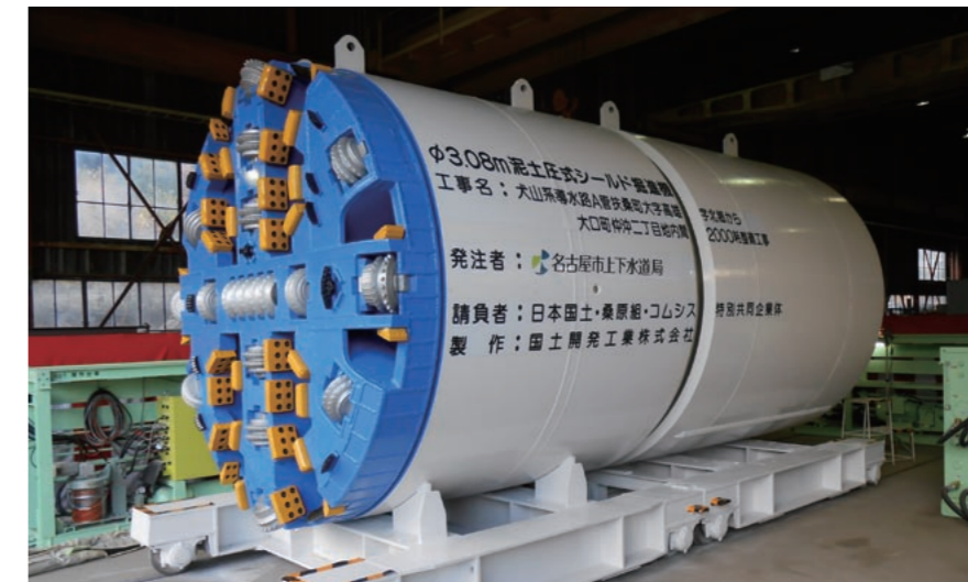
上/現地の状況を考慮し、検討段階でのマシンの仕様変更は6回に及んだ。幾多のワンアンドオンリーの装備を施した最新の掘進機を武器に、持てる技術の全てを注ぎ込んだ工事が展開されている（提供：日本国土開発株）。 下/チャンバーには、万一の閉塞時に圧密した玉石を動かすことのできる専用ジャッキを備えている。これも通常のシールドマシンにはない装備だ（提供：日本国土開発株）。
