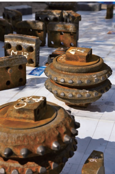
役割を終えたビット。歯車のようなローラービットの重さは80kg、この突起を玉石に押し当てて破碎する。奥に写るカタビットとも、掘進した距離より稼働した時間で交換時期を想定する。
