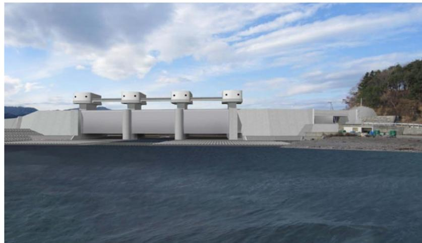
完成予想パース。延長約100m、3径間の水門を築造する(提供：飛鳥建設(株))。
