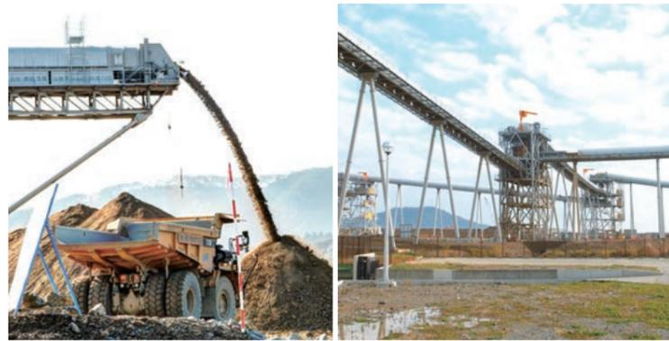
右2点/今泉地区に設置されている破砕設備。発破作業により発生した岩石を300mm以下に砕き、ベルトコンベアに投入する。稼働状況は設置された50台以上のカメラによって中央操作室でリアルタイムで監視されている。
