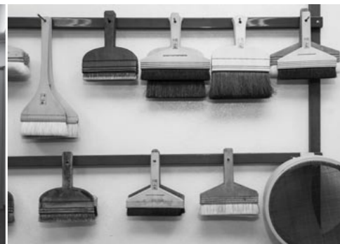
左/旧安田楠雄邸は、1919(大正8)年に建設された近代和風建築の一つ。1998(平成10)年に東京都指定の文化財となり、翌年から大規模な修復工事が行われた。(提供:(公財)日本ナショナルトラスト) 中/今回の工事では、若い世代(左から尾島・島田・寛各一級技能士)が段取りや下ごしらえを経験した。「和紙の難しさ、不安定さっていうのは使っていないと理解できないんで」(榎池袋松屋のラボにて撮影) 右/和紙に糊を塗る刷毛、和紙を貼る時に撫でつける刷毛などさまざまな種類を使い分ける。
