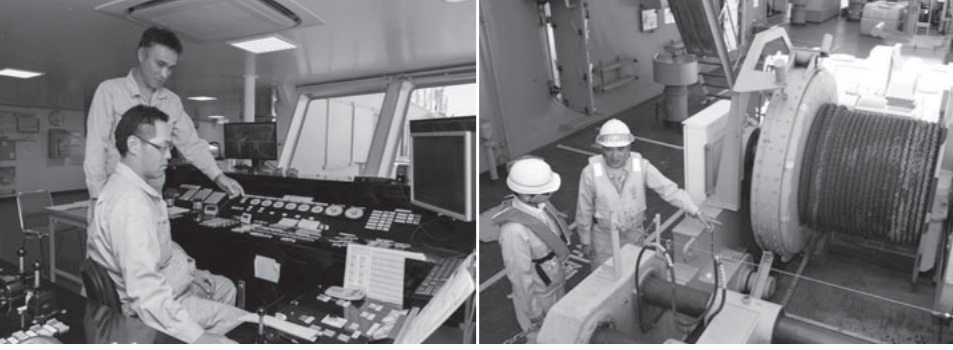
左/「昔は見よう見まねだったけど、今は先輩が後ろに立って教えます。ボタンの一つ一つ、作業内容も解説付きで」 右/高精度の施工には、船体の安定も不可欠。風・波・潮を把握しつつ、ワイヤー操作によって打設位置を決めるのも甲板職の重要な仕事だ。
