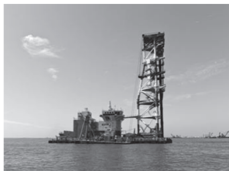
左/江川が船長を務める深層混合処理船・ボコム12号。 中/長さ51m以上の改良軸の先に掘削翼が取り付けられており、そこからセメント固化剤を吐出する。船の位置調整にはGPSを用いるため、改良の精度も高い。 右/左から、五洋建設・嶋尚幸職員、江川、五洋建設・永野完児工事所長、飯塚正実職員。 「江川船長には船のことを色々と教えてもらっています」と入社2年目の飯塚職員は話す。
