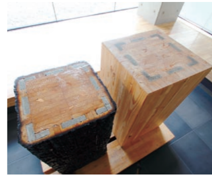
耐火実験の際に使用された「燃えエンウッド」のサンプルがエントランスに展示されている。「燃え尽きない」新しい資材の性能が一目瞭然だ。(図提供：株式会社竹中工務店)
