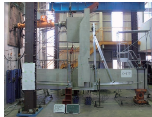
PCaPCには作り方が決まれば量産できるという利点があるが、ラインに乗せる前に部材の強度と精度を確認するため実物大試験を行った。
