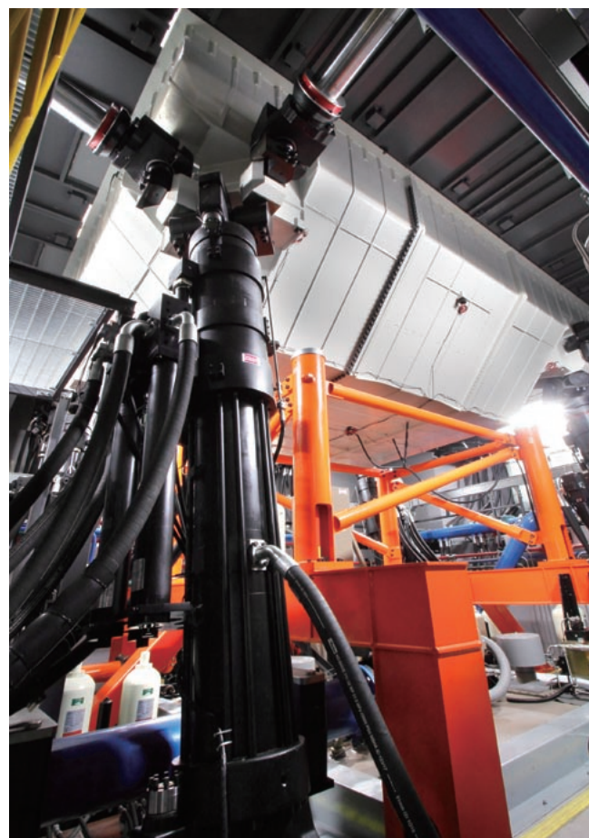
主振動台の四隅に取り付けられた高速油圧加振機（アクチュエータ）。40tの鋼製テーブルを3方向に加振して様々な地震動を人工的に発生させる。このシステム全体は空気ばねとダンパーで支えられた巨大な浮き基礎内に構築され、実験で生じた振動が周辺敷地に伝わらないよう配慮されている。
