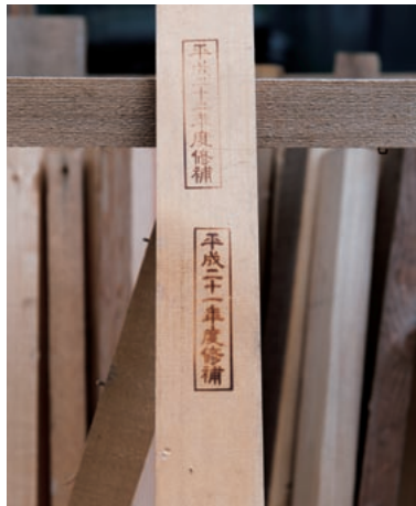
右／「焼印」は新たに使用する木材に押される。これにより改修時期を後世に伝える。 左上／解体時、既存建具や床板一枚ごとに「番付」と呼ばれる札が付けられる。写真は 建具に貼られた「番付」。これにより、どこで使われていた部材かわかる。 左下／現場で使用する仕口、継ぎ手形状の検討に使われた原寸大模型。
