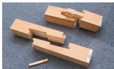
右／「焼印」は新たに使用する木材に押される。これにより改修時期を後世に伝える。 左上／解体時、既存建具や床板一枚ごとに「番付」と呼ばれる札が付けられる。写真は 建具に貼られた「番付」。これにより、どこで使われていた部材かわかる。 左下／現場で使用する仕口、継ぎ手形状の検討に使われた原寸大模型。
