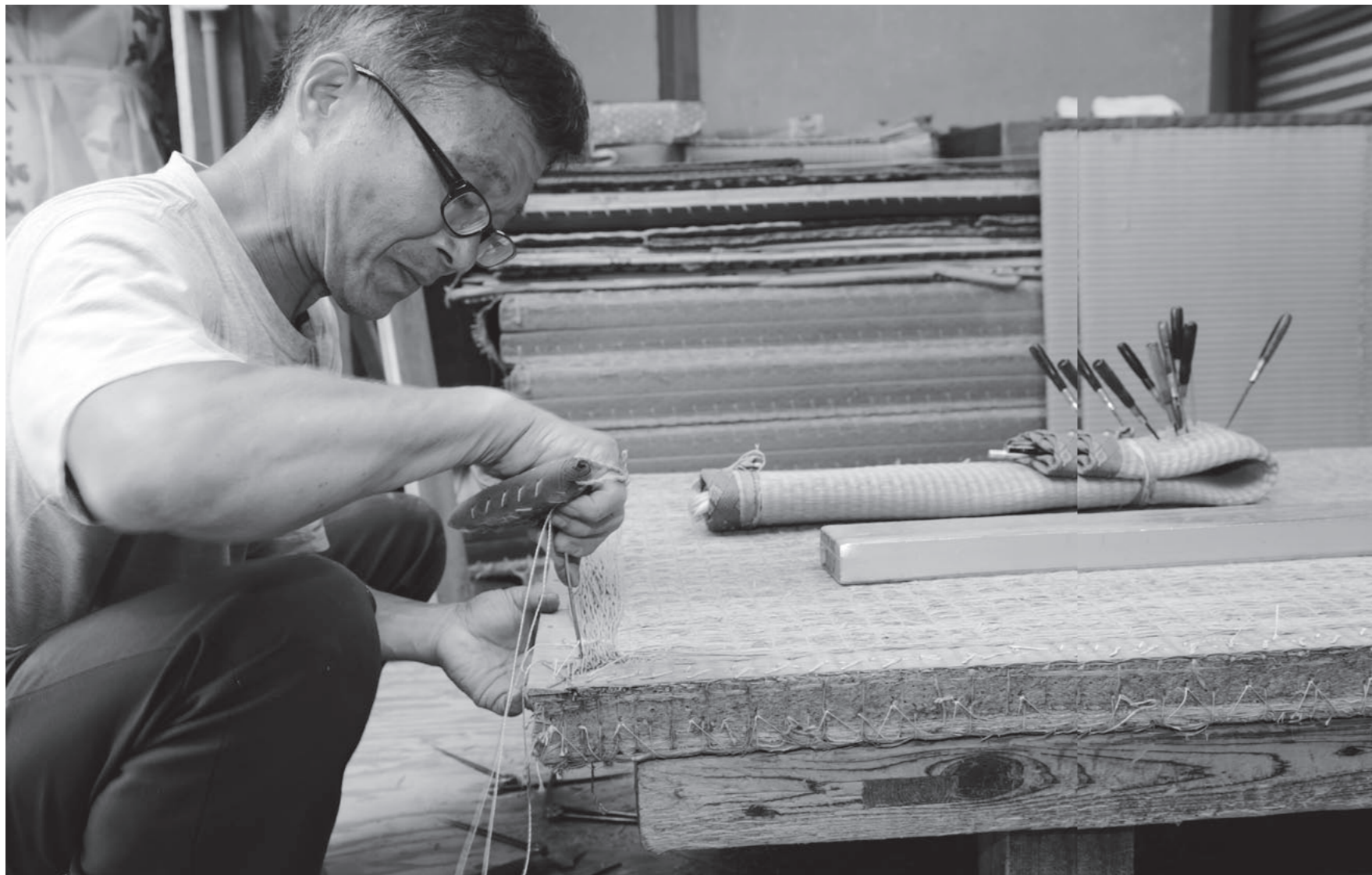
畳床の外周部を補修して縫い直す。分厚い畳床に何度も針を貫通させる重労働だ。「観光で通りかかった人に、『この畳屋さん、手でやってるよ』って珍しがられます」
