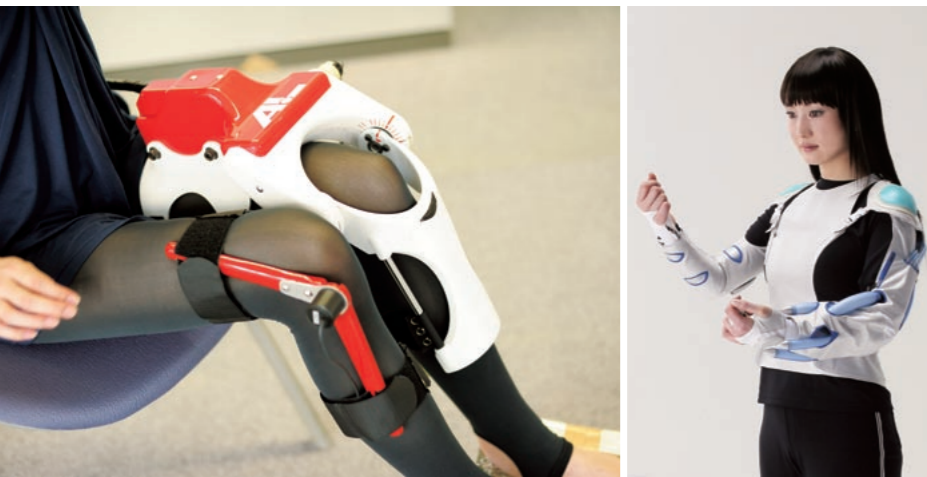
左/リハビリ研究の一環として東京大学医学部に納入された「下肢用パワーアシスト装具」。 右/「上肢リハビリ支援スーツ」はTIME誌の「Best Inventions 2006」に選定された。 (写真：アクティブリンク株)
