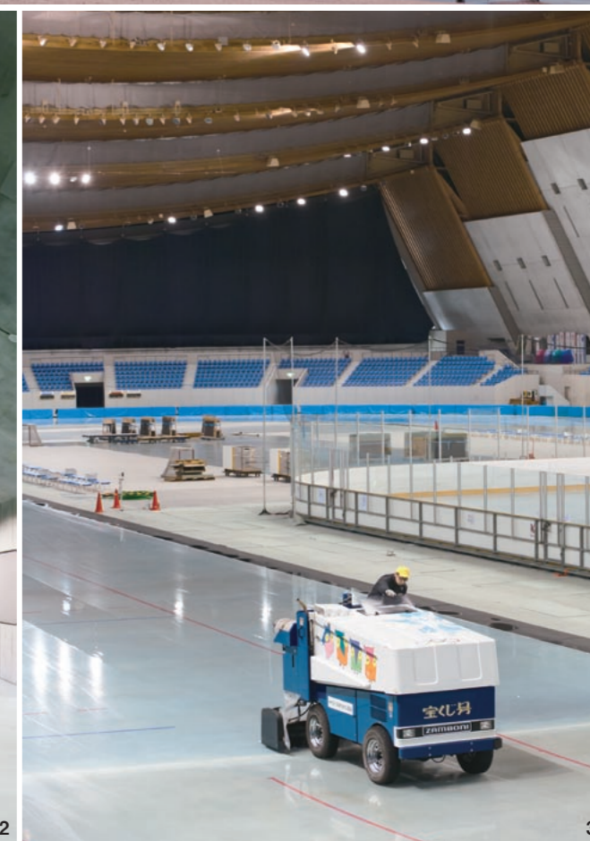
1 ステンレス板葺きの外壁。ステンレス板の形状を一段おきに変化させ、外観に豊かな印象を与えている。2 内部コンコース。重なりながら並ぶ斜めの外壁の様子が室内にも現れている。3 スケートの刃によって出来た溝を整えるための整氷車。ミリ単位の溝を何周もかけて回りながら、平らにしていく。(写真：山田新治郎)
