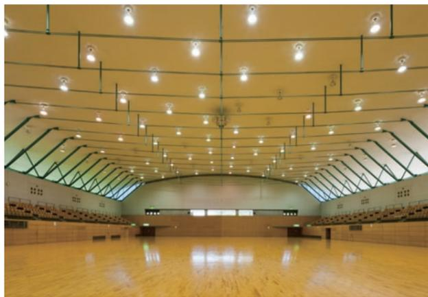
メインアリーナ。54mのスパンをレンズ型張弦梁とキャンチトラスからなる構造システムによって支えている。
