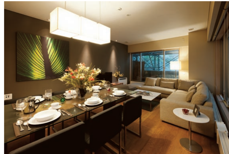
躯体工事と平行してつくられた先行モデルルーム。窓の外には外部足場が見える。海外の施主に対して、実物大のサンプルで施工承認をもらうために製作した。
