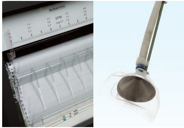
現場を包囲するように各種センサーが配置されている。写真は粉じんの量を計測する「SPM計」。
