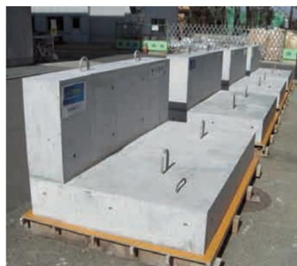
海水練り・海砂コンクリートを用いたモデル試験体
