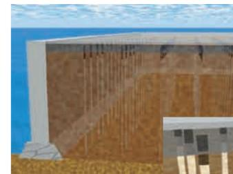
地震時に、過剰間隙水圧を消散させることによって液状化を防止
